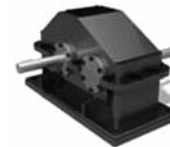
Рисунок 2 — 3D модель циліндричного косозубого редуктора, виконана у програмі Autodesk Showcase 2015
